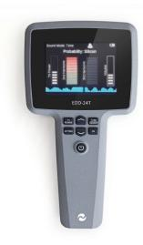
EDD-24T は、手持ち型で誰でも簡単に使える検知器で、実証済みの技術に基づいて埋設された電子機器(携帯電話、カメラ、無線発信機、録音機など)を通電中・非通電中またはスタンバイ中に拘らず検知します。
